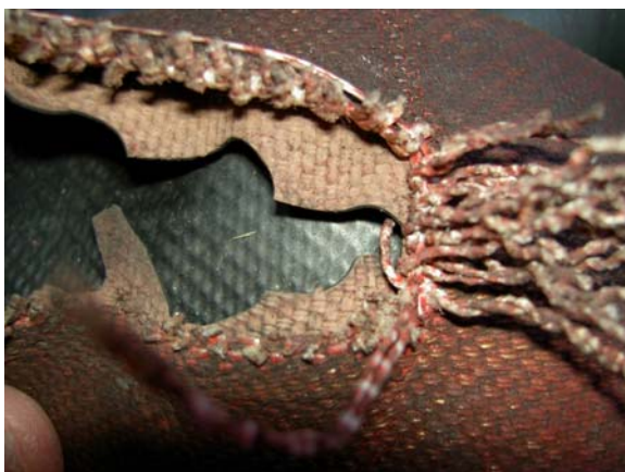
Bilder 12 bis 14: Schadenbild durch Schlauchplatzer
